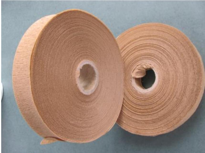
工艺性差。有机材料一般为聚合物，平均分子量在104~106之间，其耐热性通常低于无机材料。含有芳环、杂环和硅、钛、氟等元素的材料其耐热性则高于一般线链形高分子材料。影响绝缘材料介电性能的重要因素是分子极性的强弱和极性组分的含量。极性材料的介电常数、介质损耗均高于非极性材料，并且容易吸附杂质离子增加电导而降低其介电性能。故在绝缘材料制造过程中要注意清洁，防止污染。电容器用电介质要求有高的介电常数以提高其比特性。菱格点胶绝缘纸产品特点及用途：本产品是将特种改性环氧树脂呈菱格状在电工绝缘纸上的绝缘材料。点胶纸普遍地应用于油浸式电力变压器的层间绝缘及匝间绝缘，使用时涂覆层在线圈干燥过程中在一定温度时开始熔化，产生粘附作用，随着温度的升高又开始固化，使绕组的相邻各层可靠地粘合成一个固定单位。环氧树脂的粘合强度足以防止短路时绕组各层的位移，从而保证了绝缘结构长的电气和力学性能。由于菱格点胶纸的树脂涂层呈点状，保证了油的浸入和绝缘材料中气体的排出，有效地避免电晕和局放，从而保证了绝缘结构的安全、可靠。亦可作电缆屏蔽隔离层及高压电机、电器的防电晕材料。
